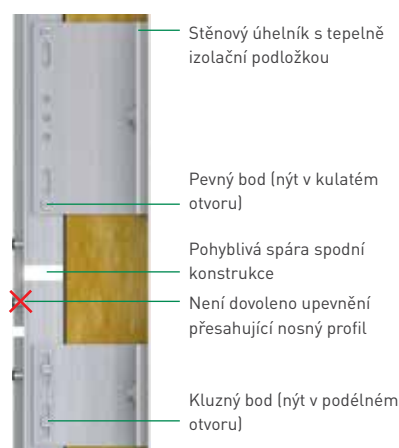
Detail A: Vytvoření pevného a kluzného bodu spodní hliníkové konstrukce
