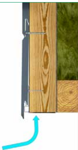
Upevnění ventilačního profilu
