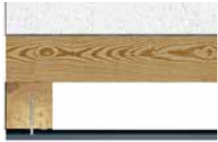
Zarovnání fasádního obkladu u okeního ostění
