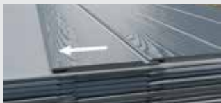
Fasádní obklady Hardie® VL Plank jsou vzájemně zastrčené do sebe. Palubky při odebrání z palety je nutno napřed vysunout a pak teprve zvedat.
