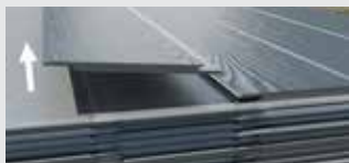
Fasádní obklady Hardie® VL Plank jsou vzájemně zastrčené do sebe. Palubky při odebrání z palety je nutno napřed vysunout a pak teprve zvedat.
