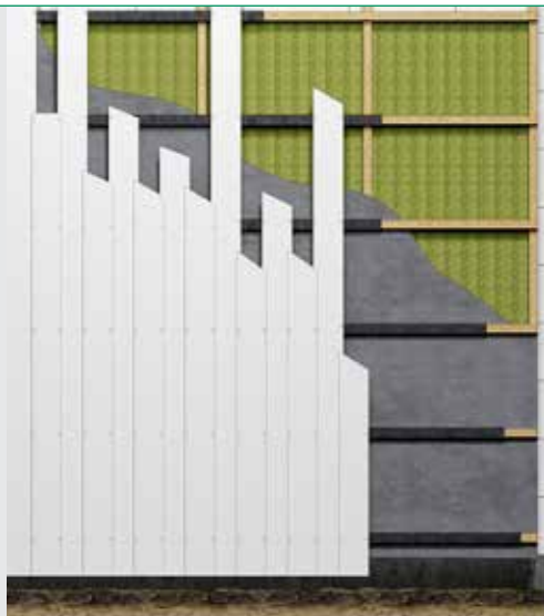
Montáž – dvojitý svislý záklop
