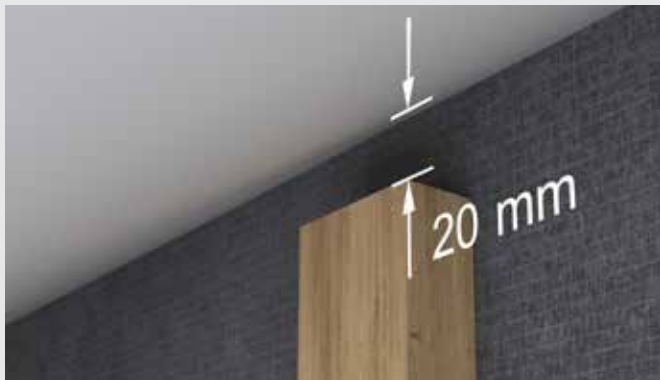
Minimální vzdálenost mezi horní hranou nosného laťování a horním ukončením.
